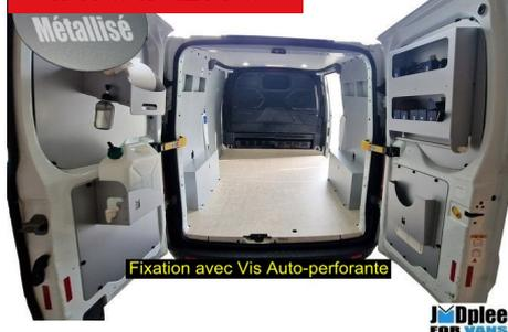
**BERLINGO M-Kit + Portes Ar Hautes + Plancher Antidérapant Pnx Particules 0 Plc**
